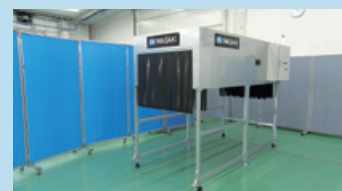
到着手荷物用UVC除菌装置
