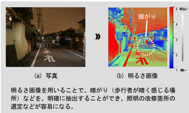
図-10 歩道の明るさ画像の測定事例
